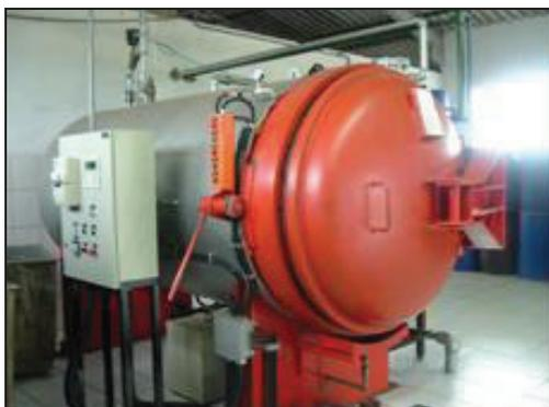
**Figura 10.2-LXXVIII: Foto da autoclave (Fonte: Atitude Ambiental)**
